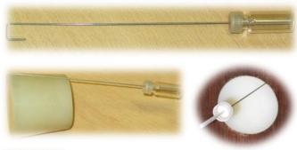
Un capteur en polymère protégé par une capsule en verre amovible, fixable sur la bonde à l'aide d'une simple broche.
