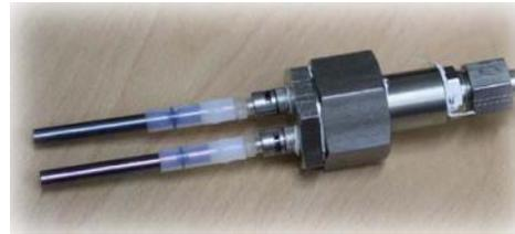
2 cartouches contenant un matériau absorbant spécifique (brevet déposé) sont introduites dans la barrique à l'aide d'une canne de prélèvement.
